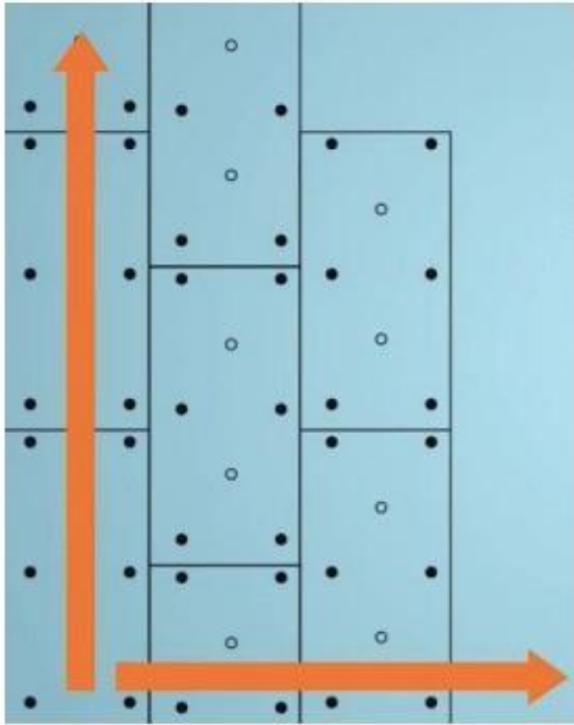
Рис. 1. Порядок монтажа панелей.
